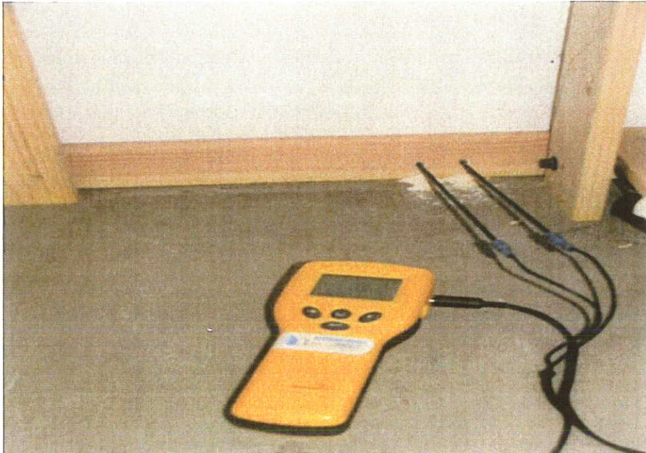
Foto 1: Registrering av fukt med fuktmåleapparat Protimeter .
